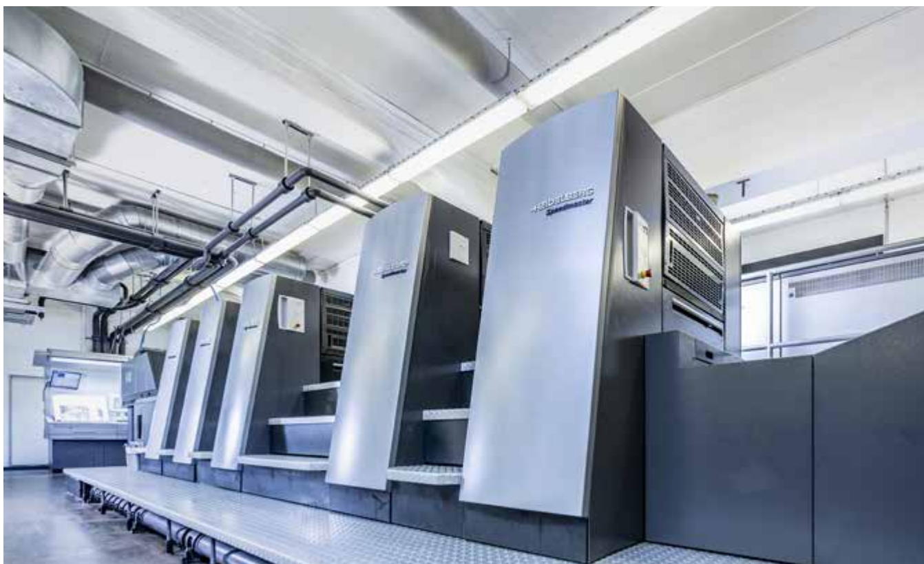
Das Flagship der Gebo Druck: Die Heidelberg 5-Farben-Druckmaschine «Greta», die sowohl quantitativ wie auch höchsten qualitativen Ansprüchen genügt. Mit dieser Maschine werden Bücher, Magazine, Prospekte und anspruchsvollste Drucksachen produziert
